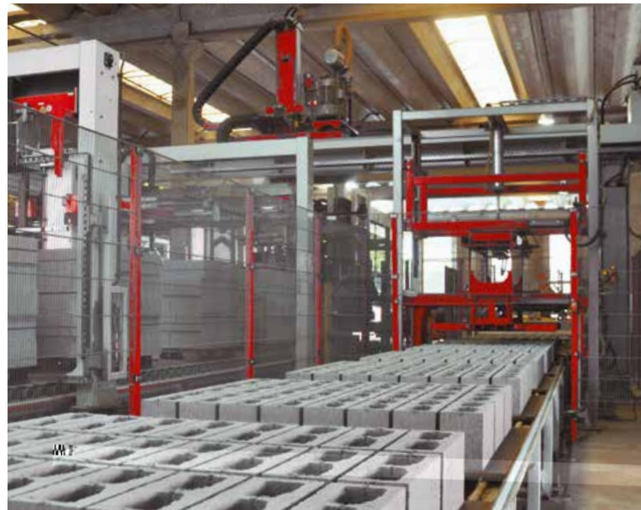
Trockenseite mit Hohlblocksteinen
